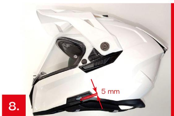
Applicare il tastierino sul lato sinistro (casco indossato), a circa 5 mm dal bordo inferiore della calotta mediante l'utilizzo dell'apposito adesivo fornito. Verificare che ci sia piena superficie di contatto tra il tastierino adesivizzato e la calotta esterna
